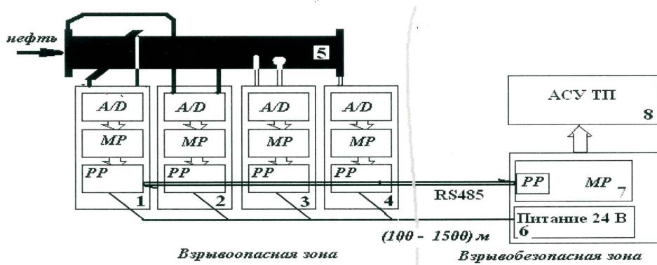
Первичный преобразователь регистратора «КВАРТА-Н-50» представляет собой конструкцию, в которой совмещены четыре устройства: специальная измерительная линия, оригинальный ультразвуковой измеритель скорости и плотности смеси, СВЧ-влагомер, измеритель влажности и специализированный вычислитель. Эти устройства конструктивно объединены в одном блоке, но функционируют независимо друг от друга. Результаты измерений каждого из этих устройств используются в
